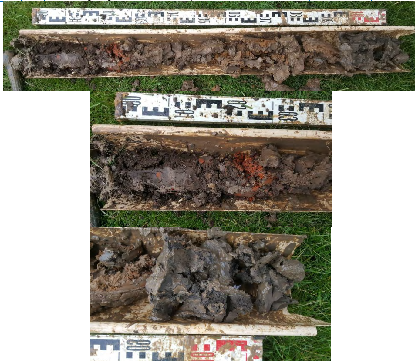
Traits rédoxiques marqués à partir de 30 cm et horizon réductique à partir de 90 cm
